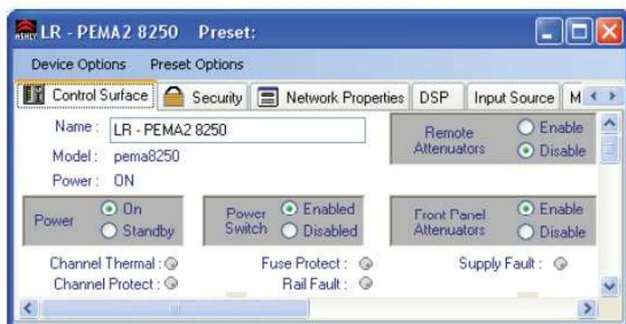
**Channel Thermal** – Diese Software LED leuchtet wenn der Kanal eine ungewöhnliche, zu hohe Betriebstemperatur erreicht.
